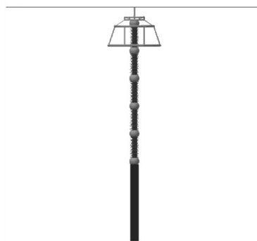
图 1 1 000 kV 氧化锌避雷器模型
